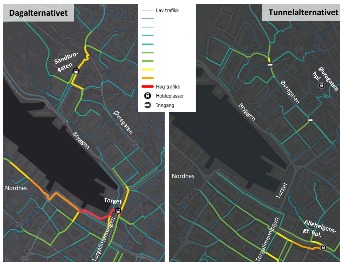
Figur 4-2: Gangstrømmer fra holdeplasser i sentrum. Figurene viser at dagalternativet bringer aktivitet til Torget i stor grad samtidig som Sandbrogaten bringer aktivitet til et byrom med lite byliv i dag. Holdeplassen i Øvregaten bringer relativt moderate gangstrømmer til Øvregaten, et område som er ganske travelt allerede, uavhengig av banen. Holdeplassen i Allehelgens gate bringer noe mer aktivitet til området mellom Rådhuset og Domkirken enn dagalternativet.
